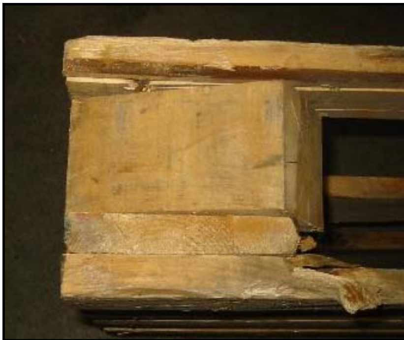
Abb. 1: Tauschfähig: Verdrehter Klotz mit einem Überstand kleiner 1 cm
