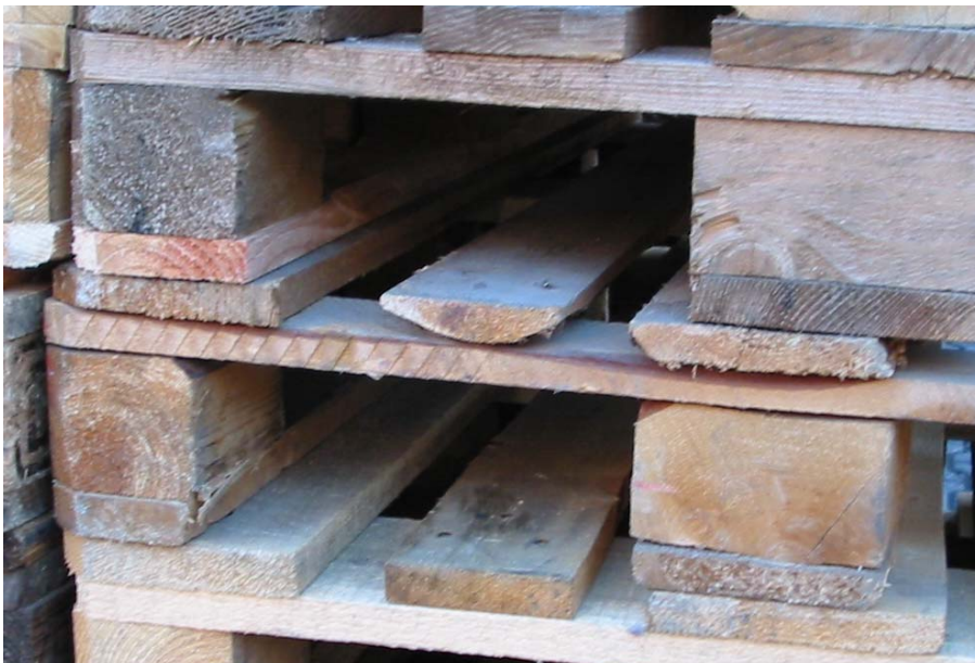
Abb. 3: Nicht tauschfähig: Unsachgemäß reparierte Palette mit einem unzulässigen Deckbrett
