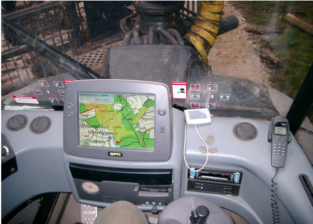
Abbildung 2: Moderner Arbeitsplatz in einem Forwarder mit PC, GeoMail im Kartenmodus
